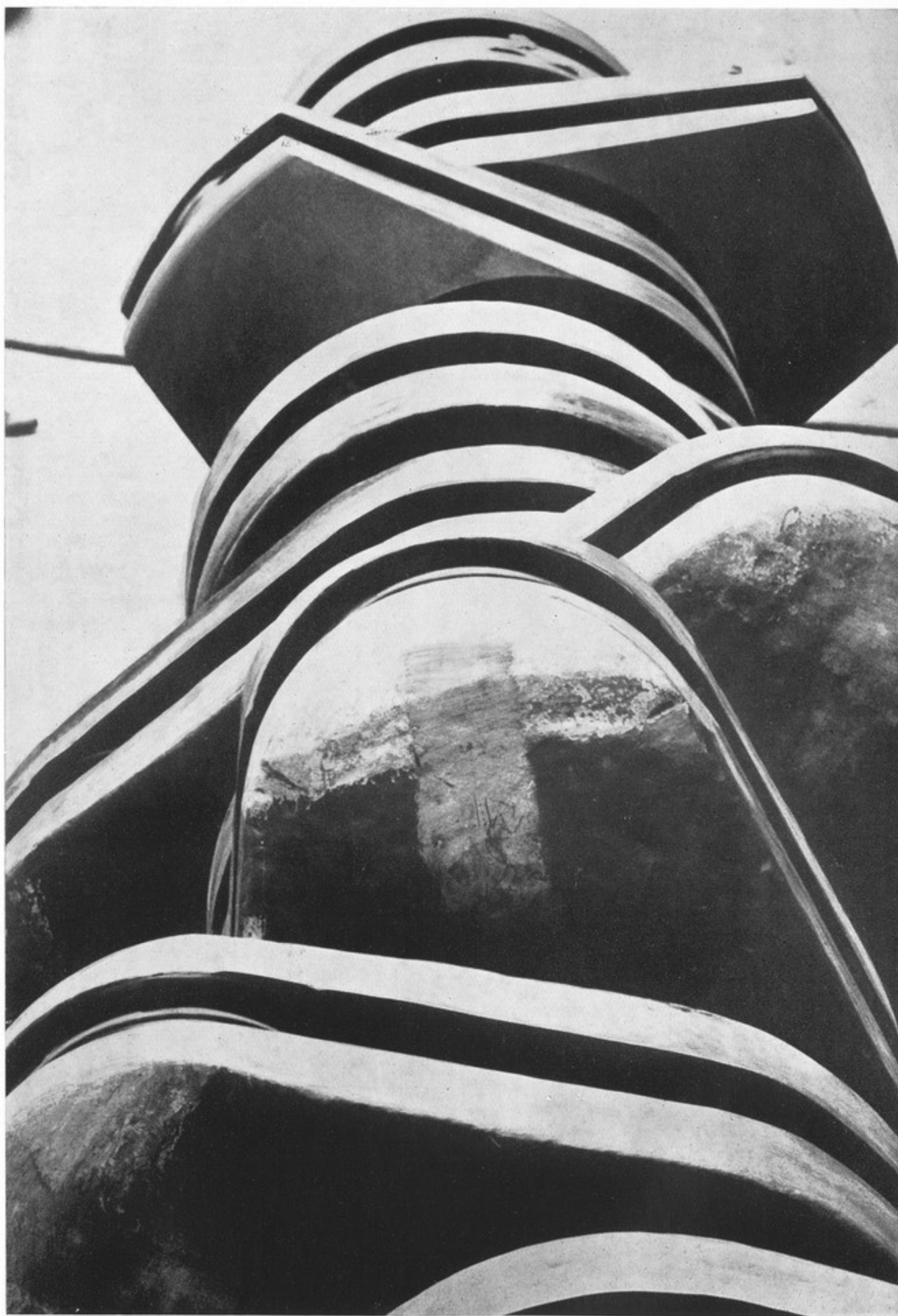
Una suggestiva inquadratura di un grande albero a manovella per motore marino del peso di circa 60 tonnellate. Questa è un'altra delle specializzazioni produttive dello stabilimento di Campi, dove esiste un'officina meccanica particolarmente attrezzata per tale lavorazione. Dal 1951 al 1961 lo stabilimento SIAC ha prodotto oltre milleseicento alberi a manovella, prevalentemente di medie e grandi dimensioni, per la clientela italiana ed estera.
