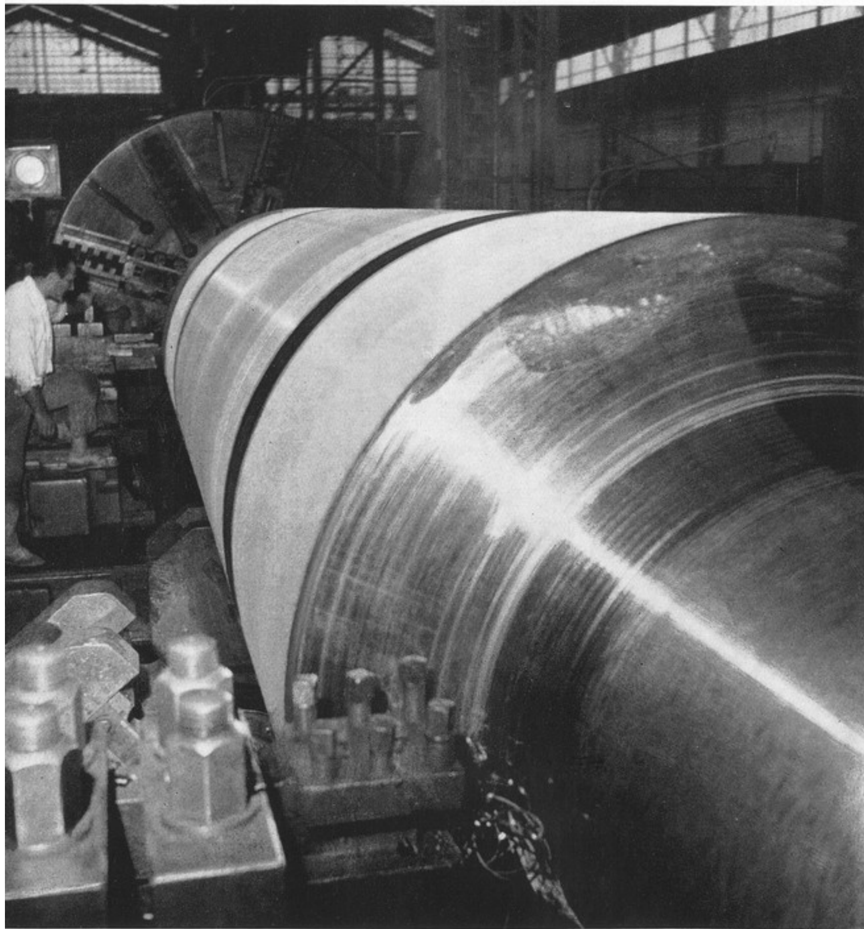
Una lavorazione meccanica dello stabilimento SIAC dell'Italsider: un grande rotore di acciaio fucinato in fase di tornitura. La produzione di rotori costituisce una delle specializzazioni principali dello stabilimento, ed è particolarmente apprezzata sui mercati esteri. Il più grande rotore sinora realizzato a Campi, ricavato da un lingotto di oltre 160 tonnellate, pesava, a lavorazioni ultimate, 87 tonnellate. Era destinato alla centrale atomica canadese di Douglas Point.
