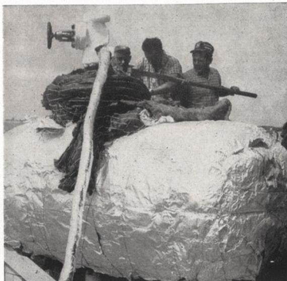
Il cilindro di acciaio al 9 per cento di nickel, lungo 2 metri e del diametro di 1 metro, mentre viene riempito di azoto liquefatto a 196 gradi centigradi sottozero prima di essere sottoposto ad una pressione di 215 atmosfere.
