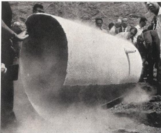
Il cilindro dopo lo scoppio. I risultati della prova di scoppio sono stati positivi.
